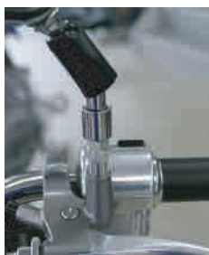
VT400Sのミラー取付部(新車時)。車両側正ネジ、ミラー側逆ネジのアダプターにダンパー付きアダプターが装着されてブーツで覆われている。
